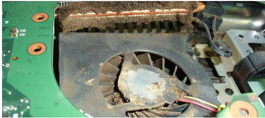
Slika 3. Jedan od najčešćih problema u radu računara je zaprljan ventilator za hlađenje CPU (izvor: http://www.daftdog.co.uk , feb. 2013)
