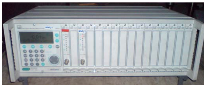
Slika 5. Modularni uređaj za mjerenje HBM MGCplus
