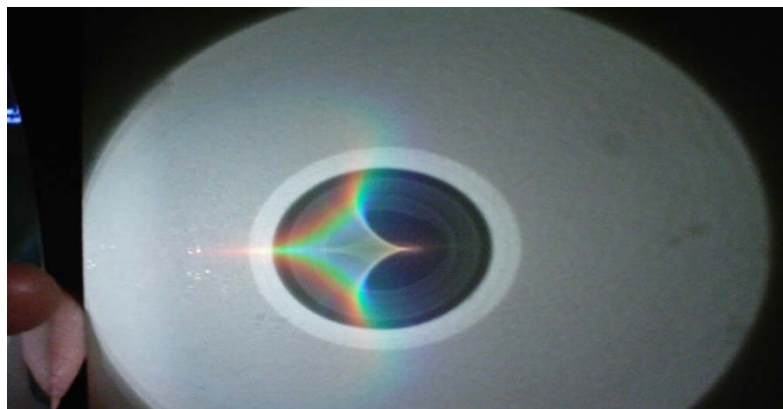
Slika 10. CD kao vrsta optičke rešetke [7]
